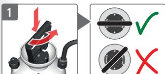
Pumpe korrekt entriegeln
