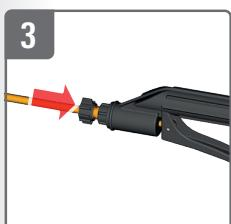
Sprührohr an Handventil schrauben
