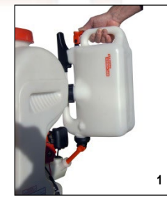
Vul de tank door de jerrycan verticaal te houden (1). Veeg de kan om de tuit helemaal leeg te maken (2).
