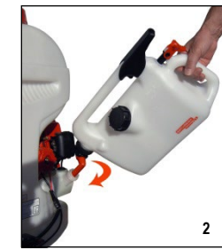
Vul de tank door de jerrycan verticaal te houden (1). Veeg de kan om de tuit helemaal leeg te maken (2).
